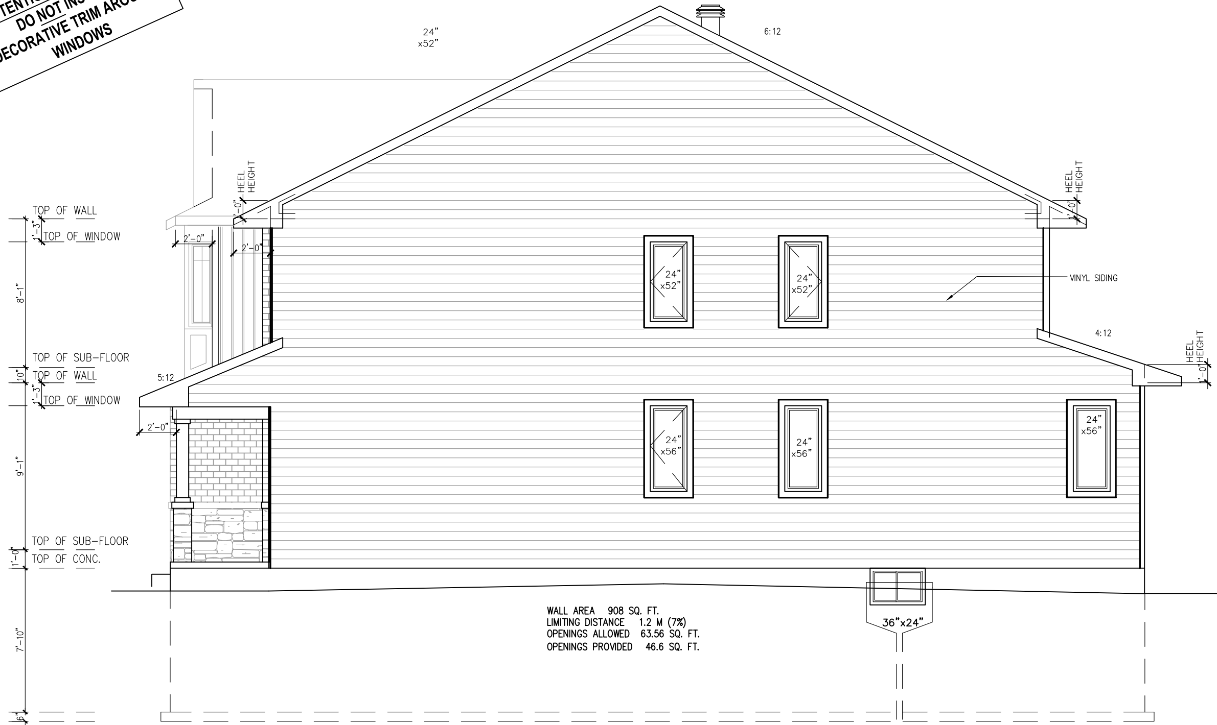
RIGHT SIDE ELEVATION ELEVATION E
