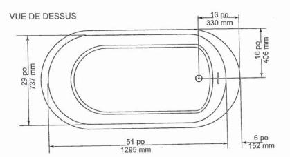
SPÉCIFICATIONS GÉNÉRALES Polds moyen Partle baignoire au bas 43 po x 20 po 1092 mm x 508 mm Capacité jusqu'au niveau du trop-plein 195 litres Profondeur d'eau entre l'orifice d'évacuation et le trop-plein Diamétre du drain 16 po 2 po 51 mm 2 ½ x ½ po 57 x 13 mm 3 ½ po 83 mm Ouverture du trop-pieln Dégagement du drain au plancher
